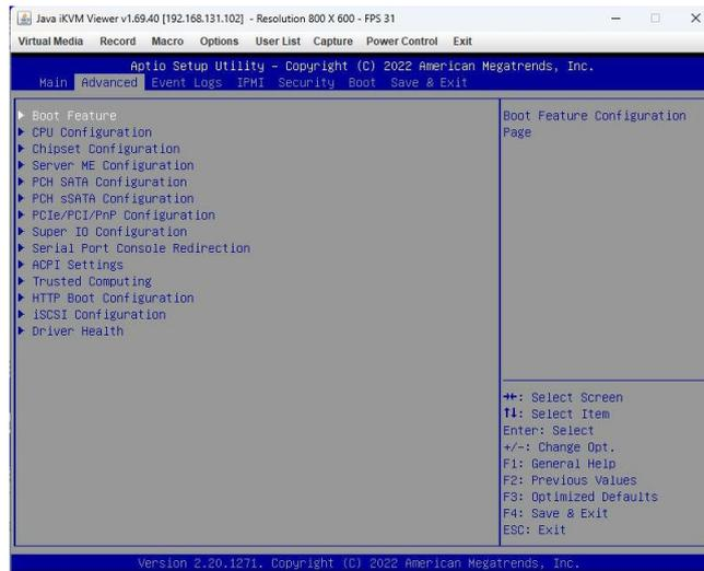
3. Selezionando la voce **Restore on AC Power Loss** è possibile selezionare l'opzione **Power On**
